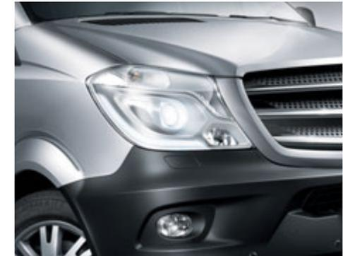
○ **Bi-Xenon-Scheinwerfer mit LED-Tagfahrlicht und -Abbiegelicht.** Durch bessere Ausleuchtung des direkten Seitenbereichs erhöht sich die Sicherheit.
